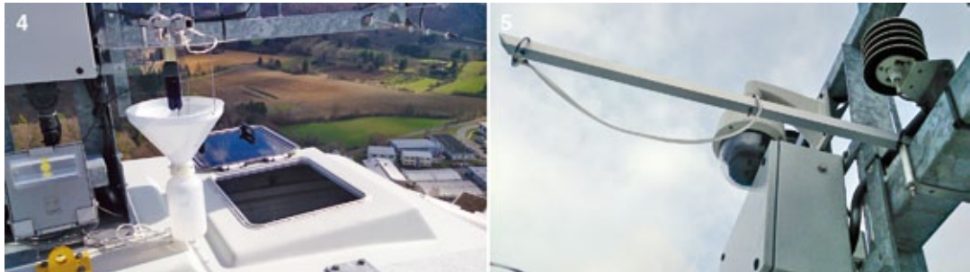
Abbildung 4, 5. Zwischen der Luke (Abb. 4) und dem Signalleuchtenträger (dem sogenannten Geweih) (Abb. 5) konnte die Lichtfalle sicher befestigt werden. Ihre Maße sind aber dadurch auf 30 cm Durchmesser und 58 cm Höhe insgesamt (mit Prallscheiben, Trichter und Sammelgefäß) beschränkt. Die Falle wurde von M. FALKENBERG konstruiert und hergestellt. – Fotos: M. FALKENBERG.
